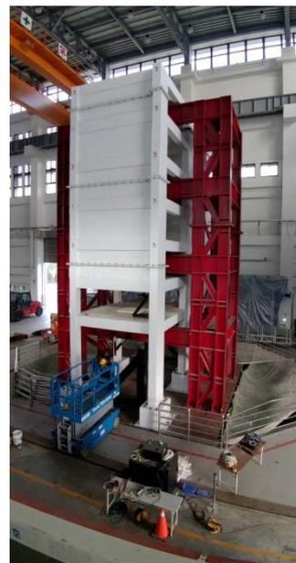
試體照片- RC 軟弱底層建築物試體置於振動台
